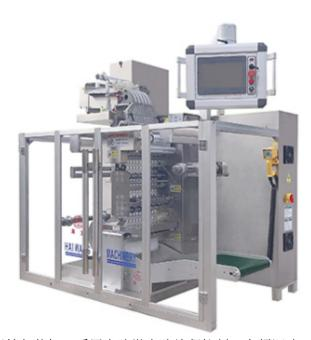
SHW-APM系列高速自动铝箔包装机,采用电脑微电脑编程控制,变频调速,触摸面板操作。送料、成型、热封、压痕打批号、冲裁等工序全部连续自动完成,其特点有:全自动控制,包装精确美观,低噪音;外型小巧、美观、产量高;操作、维护方便;更换模具快捷省时;版面可自由调整;气动冲剪,可随意调整所需要的位置;智能型数字式温控装置,温度控制更精确;无级调速;使用铝箔纸、保丽纸,适用于各种规格的片剂、胶囊剂、软胶囊剂;密封性能好,保质时间长;卷边系统,可使版面更加整洁美观,同时让您的工作场地干净、整洁、便于清场;水冷系统,保障下料系统的顺畅无忧。符合GMP要求。海南高速自动铝箔包装机上海海王机械为您提供质量可靠、保质保量的铝箔包装机。
