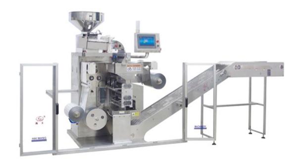
高速自动铝箔包装机具有结构先进,效率高、操作方便等特点。采用变频调速,行程可任意设定,配振动式加料机构,光电监测装置。能自动完成加料、热封、切线、打批号、裁切等系列工序。配置系列具有自动保护装置,以确保机器安全有效运行,该机器适用于医药行业制造片剂、胶囊以及电子元器件等块状物品的包装,能起到良好的密封与避光作用,与物料直接接触的设备表面光洁、平整、无死角,易清洁和消毒、耐腐蚀,较大的延长了产品的保质期。海王机械为您提供各种铝箔包装机的供求信息价格。海南高速自动铝箔包装机
